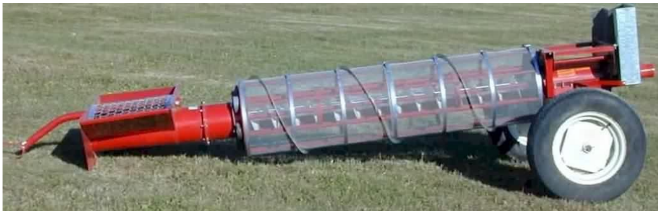
Illustration 5: Amerikansk tromlerenser, der eksempelvis kan rense kornet mens kornvognen venter på næste tømning af mejetærskeren.
